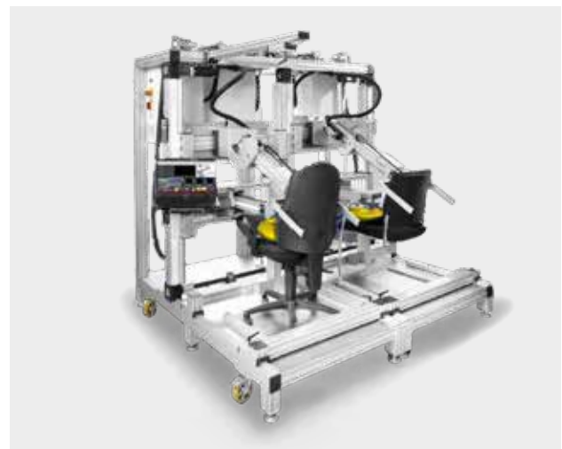
Stanowisko do badania odporności na zginanie z serwo-osiami
