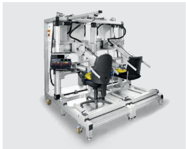
Biege-Wechsel-Prüfstand mit Servoachsen
