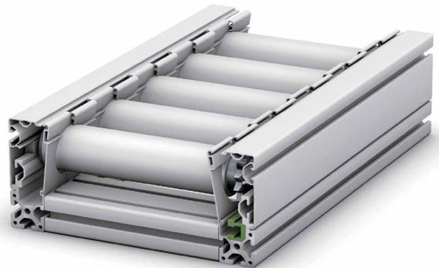
Das Rollenbahnprofil besteht aus vier einzelnen Profilen, welche durch Klippstechnik zu einem Profil kombiniert werden. Das Grundprofil bildet den Rahmen, auf dem alle anderen Profile befestigt werden. Dadurch ist eine nachträgliche Montage, sowie auch eine Demontage, im eingebauten Zustand möglich.
