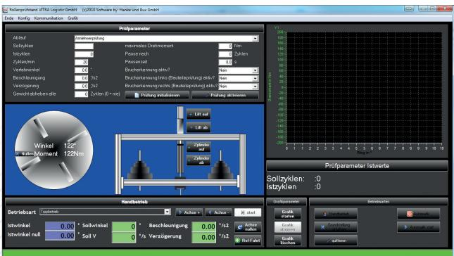
Der universelle Rollenprüfstand mit Servoachse eignet sich für die verschiedensten Prüfungen für Möbelrollen. Es können Prüfungen nach BIFMA X5.1,DIN 4551, EN1335, DIN 68878, British Standard, usw. durchgeführt werden.
