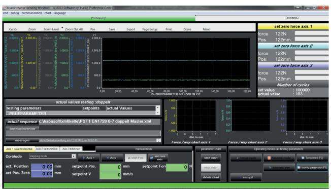
Der universelle Biege-Wechselprüfstand eignet sich für die verschiedensten Prüfungen für Stühle. Es können Prüfungen nach BIFMA X5.1, EN1335, EN581-2, British Standard, Erfassung der Federkennlinie usw. durchgeführt werden.
