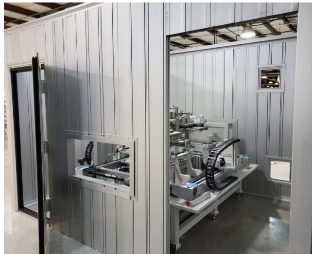
Paletti baut Laserschutzkabinen in beinahe beliebiger Größe und Form. Zu den Kunden zählt zum Beispiel die Automobilindustrie.
