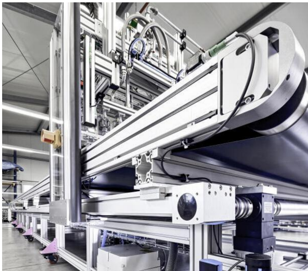
Diese Station für den Auftrag von Klebstoff bei der Herstellung von Caravan- und Wohnmobilmwänden basiert auf dem Paletti-Baukastenprofil. Sie kombiniert eine Systemlösung im Bereich Profil- und Förder-technik mit einer Lineartechnik-Lösung.
