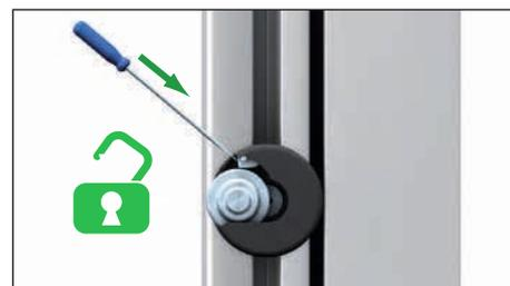
Zum Lösen des Elements den Riegel durch die Bohrungsöffnung aufschieben.
