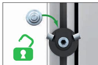
Einhängefeld wird in die Einhängung eingeschwenkt.
