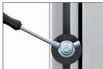
Fixierschraube schiebt sich in die Einhängung und wird durch Anziehen beider Gewindestifte gesichert.
