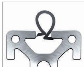
oMEGA-Schellen können an beliebigen Stellen in der Profilvernuth positioniert werden. Erst dann erfolgt die Verlegung der entsprechenden Leitungen. Werden diese nicht mehr benötigt, lassen sich die Schellen auch wieder mühelos entfernen.
