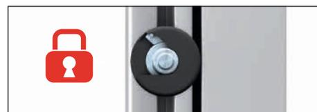
Fixierschraube in Endlage. Riegel sichert und klemmt die Fixierschraube.
